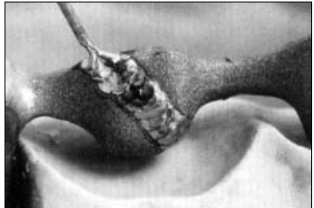
Εικ. 8. Συγκόλληση με ακτίνες laser με τη βοήθεια κόλλησης.
